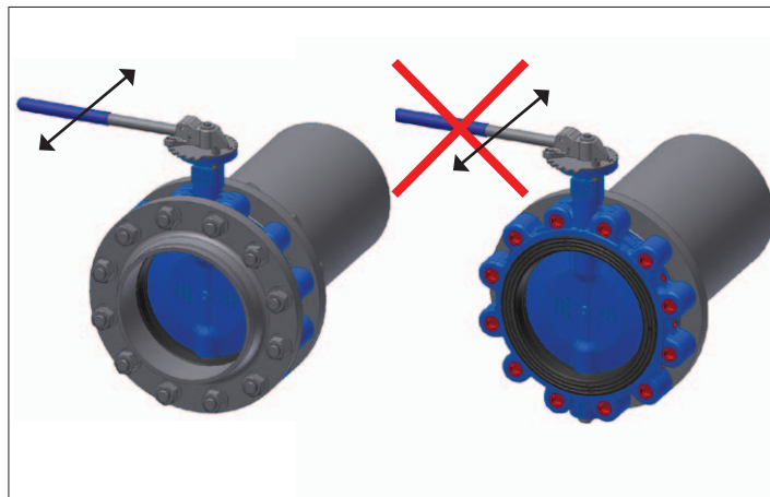
Рис. 5: Поворотный затвор VAG CEREX® 300-L как конечная арматура - обязательно с ответным фланцем!
